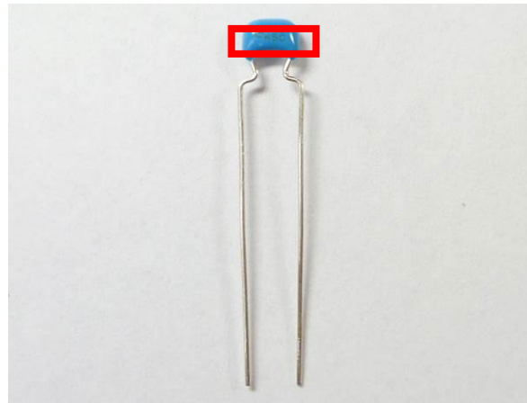
積層セラミックコンデンサ (値の読み方, 付録参照)
