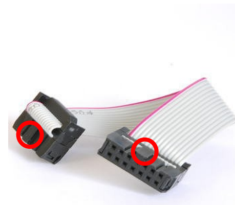
※写真はLFCBL14-01の物です。 (o) 10芯フラットケーブル (10P ボックスの切り欠き向きに挿入)
