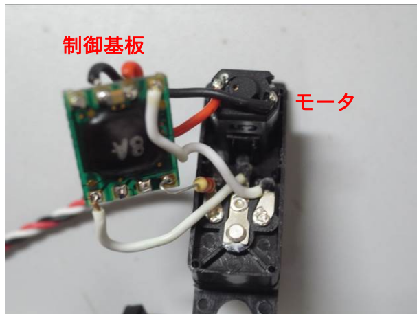
(2) 制御基板とモータが見える位置に固定
